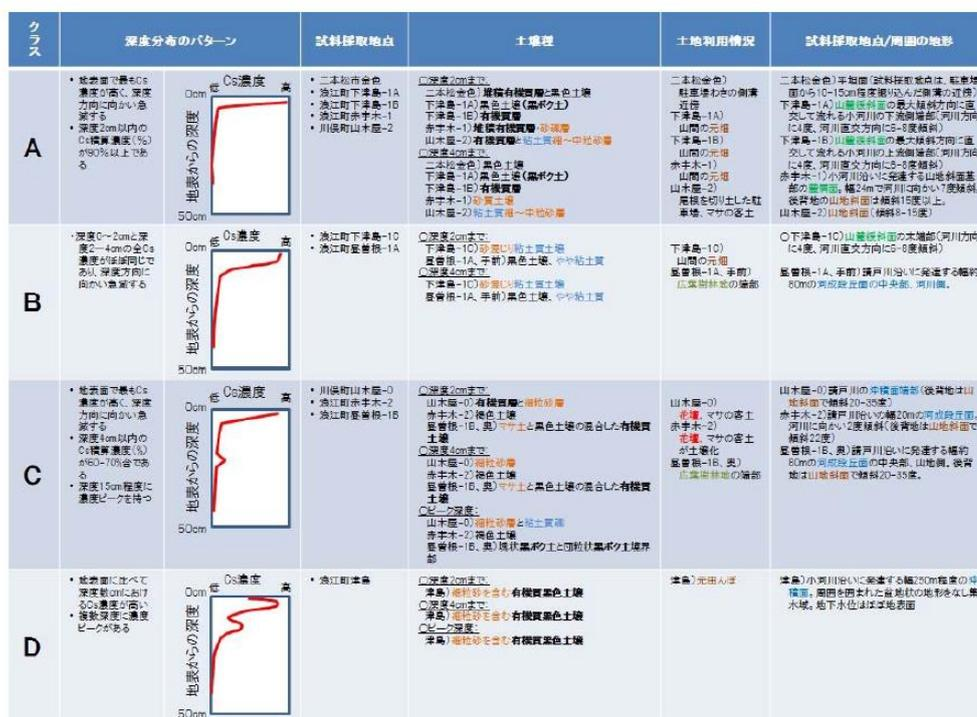
図 3.2.4-3 土壌中深度方向の放射性セシウムの分布状況に関するパターン分類 (クラスC及びDにおける濃度ピークは、表面濃度に比べて数桁少ない濃度での変動である)
