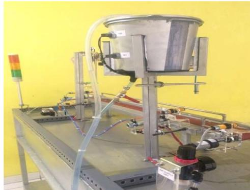
Gambar 6. Hasil produk pengembangan Training kit Mesin pengisi dan penutup botol otomatis.
