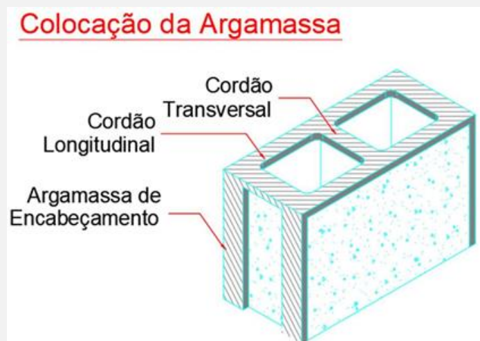
Figura 4 - Modo de aplicação da argamassa conforme projeto. Fonte: Autores.
