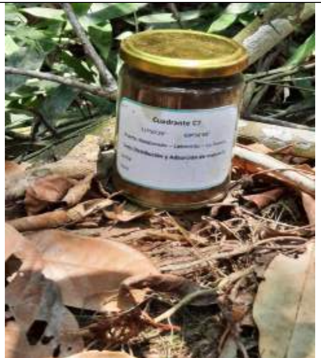
Rotulado y almacenamiento de muestras de suelo para ser enviadas a laboratorio
