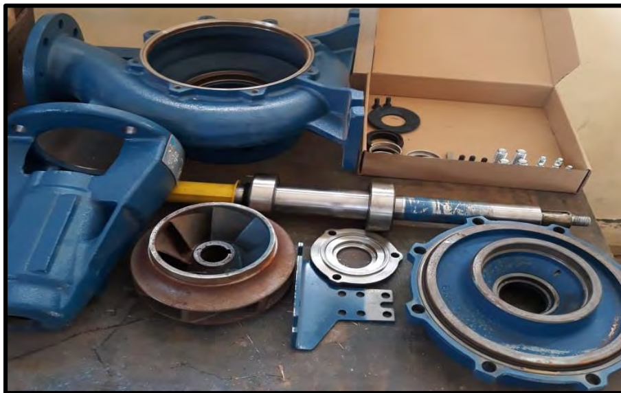
Figura 40: Bomba centrífuga desmontada. Fuente: Elaboración Propia.
