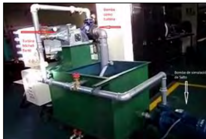
Figura 4: Módulo para BFT y turbina MB UCSM Arequipa Fuente: (Neyra & Amado, 2011)
