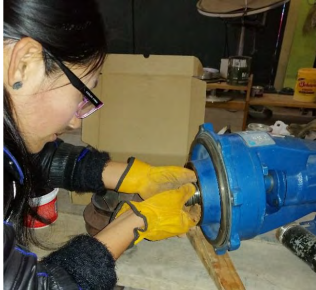
Figura 67: Comprimiendo sello mecánico. Fuente: Elaboración Propia.
