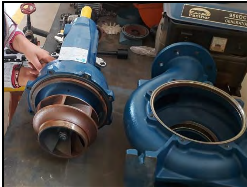
Figura 37: Desmontando: la carcasa y el rotor. Fuente: Elaboración Propia.
