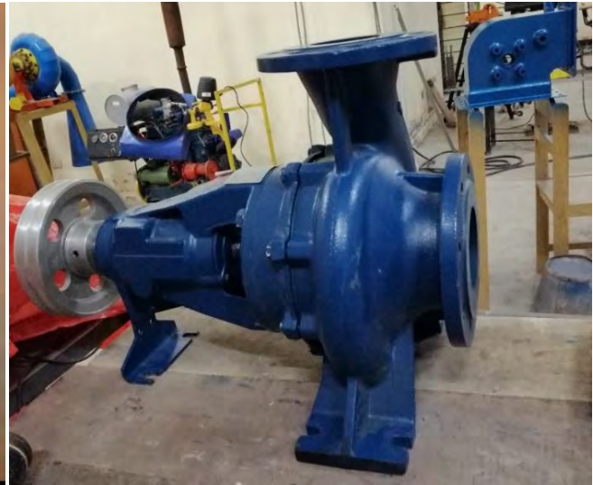
Figura 71: Colocando grasa al canal del anillo y asegurando los pernos a la carcasa. Fuente: Elaboración Propia.
