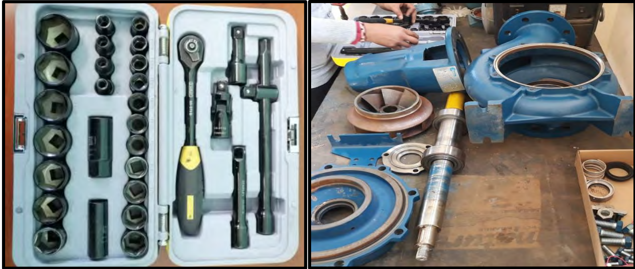
Figura 41: Juego de dados y maneral – Bomba centrífuga completamente desmontada. Fuente: Elaboración Propia.
