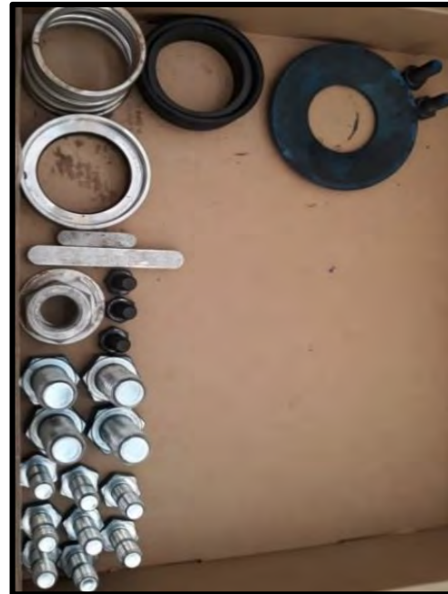
Figura 38: Desmontando: sello mecánico, chaveta y eje con los rodamientos. Fuente: Elaboración Propia.
