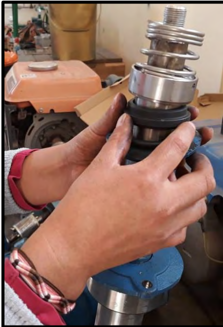
Figura 38: Desmontando: sello mecánico, chaveta y eje con los rodamientos. Fuente: Elaboración Propia.
