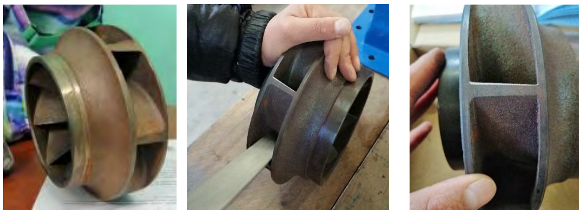
Figura 64: Limando la periferia de los álabes del rodete a la entrada del fluido. Fuente: Elaboración Propia.
