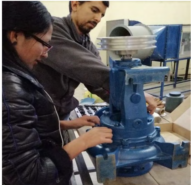
Figura 71: Colocando grasa al canal del anillo y asegurando los pernos a la carcasa. Fuente: Elaboración Propia.
