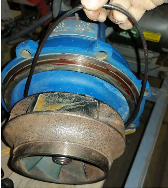
Figura 71: Colocando grasa al canal del anillo y asegurando los pernos a la carcasa. Fuente: Elaboración Propia.
