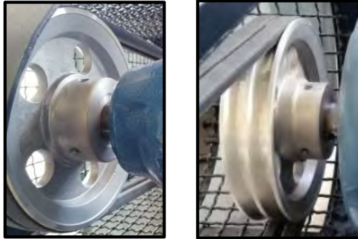
Figura 63: Adaptando los prisioneros a la polea de la PAT y al motor de inducción. Fuente: Elaboración Propia.
