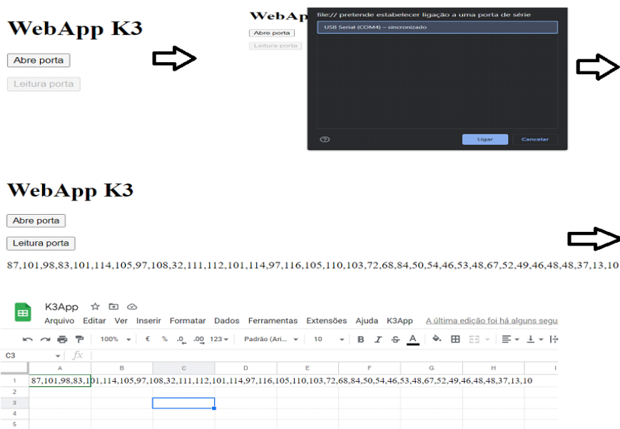
Figura 1: Simulação de teste e funcionamento do Sistema K3App de Gestão do Tubo Kalile V3.0, coletando dados de um dispositivo ARDUINO pela porta USB.
