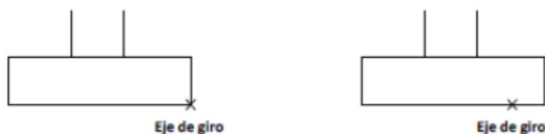
Fig. 4.46. Ubicación del eje de giro en un vuelco rígido (izda.) y plástico (dcha.).
