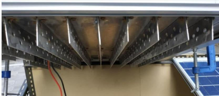
Fig. 2.10. Panel experimental incorporando aletas con agujeros en la cara posterior para reducir su temperatura de operación desarrollado por Arifin et al. (Arifin et al. 2020)
