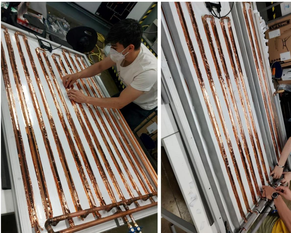
Fig. 5.5. Proceso de pegado del intercambiador de calor al panel y del recubrimiento aislante.
