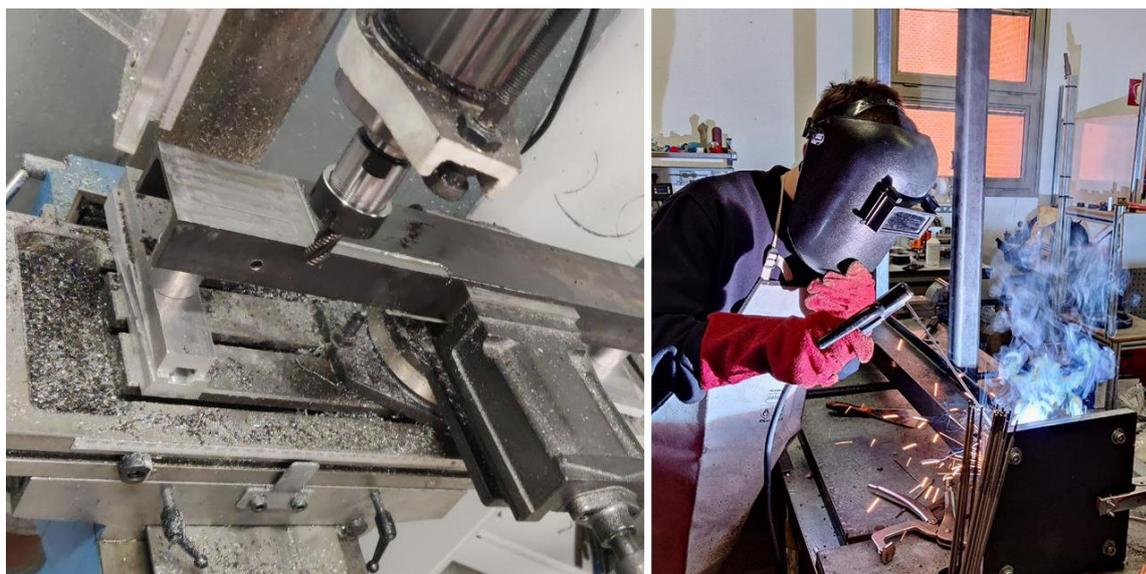
Fig. 5.8. Proceso de mecanizado de los perfiles (izq.) y soldadura de los elementos de la estructura de soporte de los paneles (dcha.).
