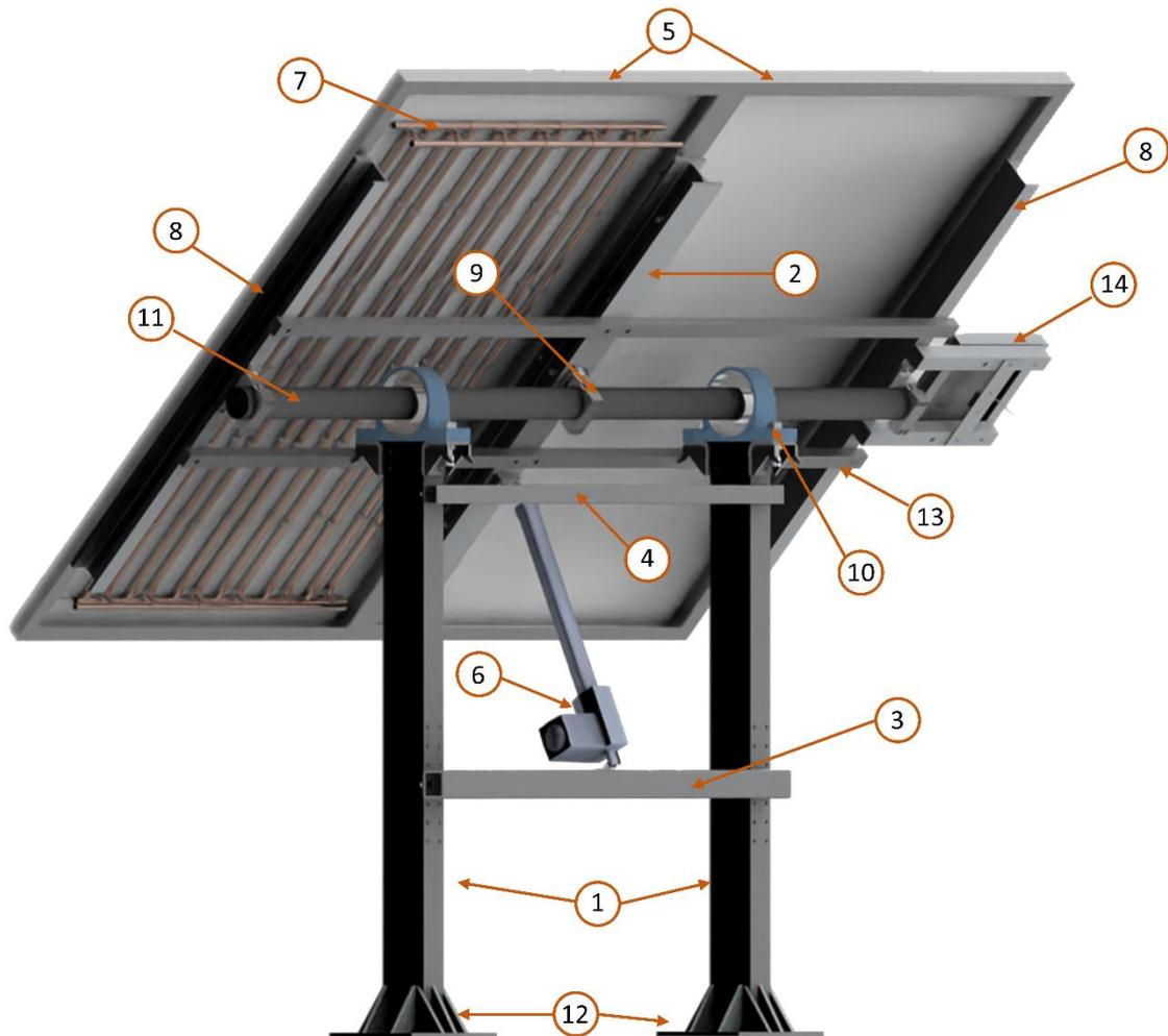
Fig. 4.32. Diagrama de la estructura de soporte con seguidor solar.
