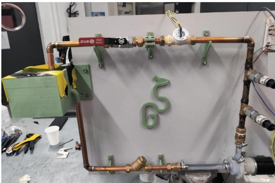
Fig. 5.13. Configuración para el ensayo de verificación de funcionamiento del caudalímetro.
