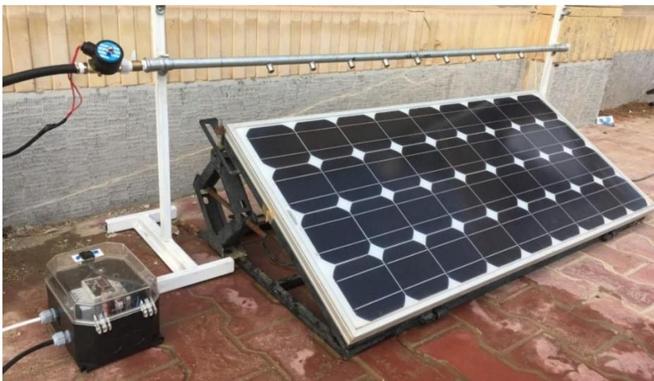
Fig. 2.14. Sistema de rociado intermitente de agua ensayado en (Hadipour et al. 2021).
