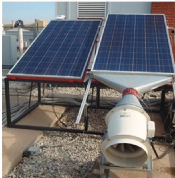
**Fig. 2.13.** Paneles solares fotovoltaicos enfriados mediante convección natural (izda.) y convección forzada (dcha.). (Mazón-Hernández et al. 2013)
