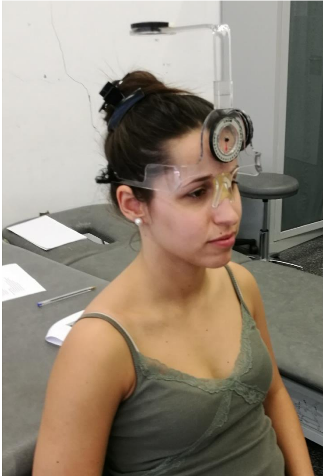
Figura 3. Dispositivo goniométrico cervical CROM utilizado para medir la amplitud del movimiento cervical.
