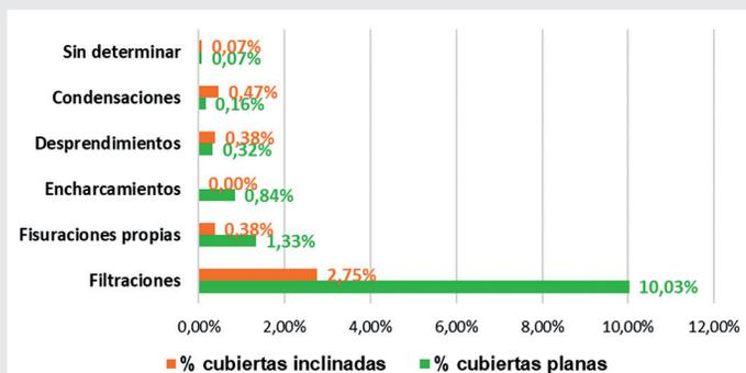
*Figura 4:* Determinación de los tipos de patologías existentes en las cubiertas según el elemento en el que se producen.
