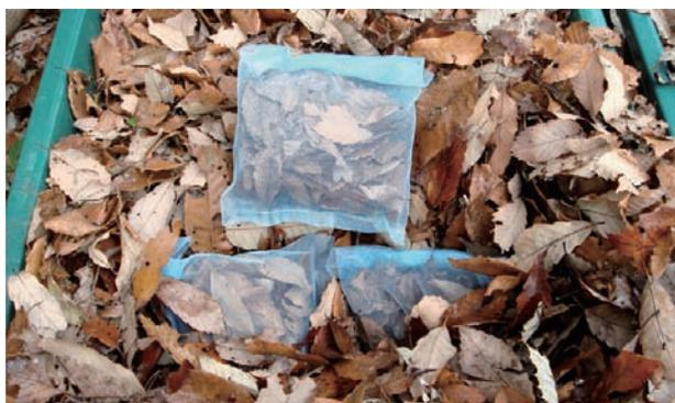
図4 落葉堆積層に埋めたりターバッグ（落葉10gの入った20cm×25cmのメッシュ袋）
