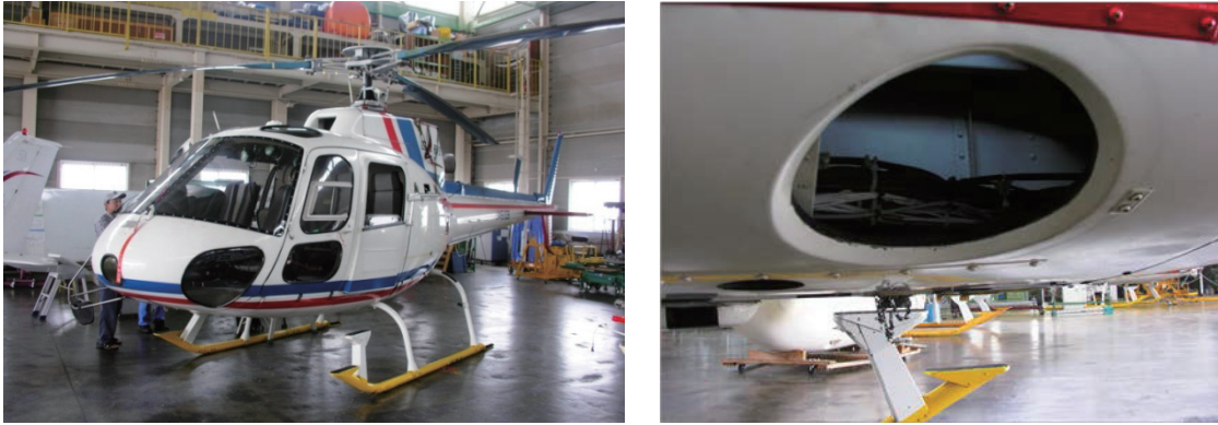
図1. 四国航空(株)所有のヘリコプターAS350B3(左)と熱赤外カメラの撮影場所(右).
