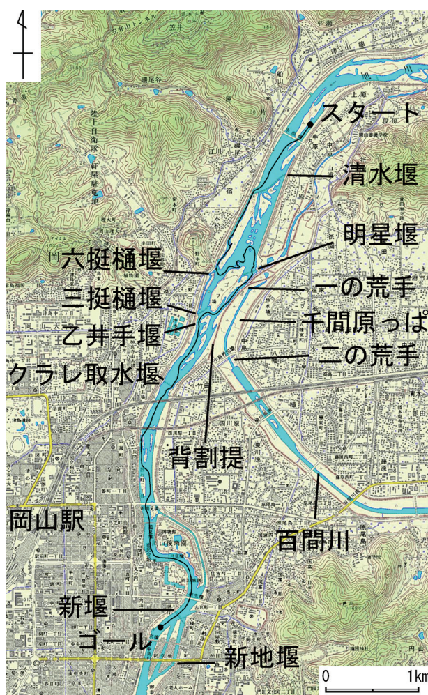
図1. カヌーによる旭川エコツアーのルート(中原橋～京橋)と河川構造物。
