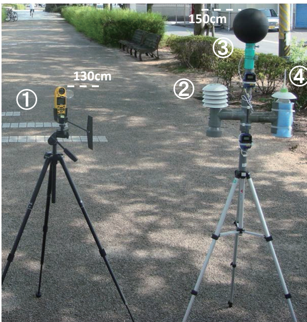
図6. 観測機器の様子. ①風向風速計, ②乾球温度計, ③黒球温度計, ④湿球温度計.
