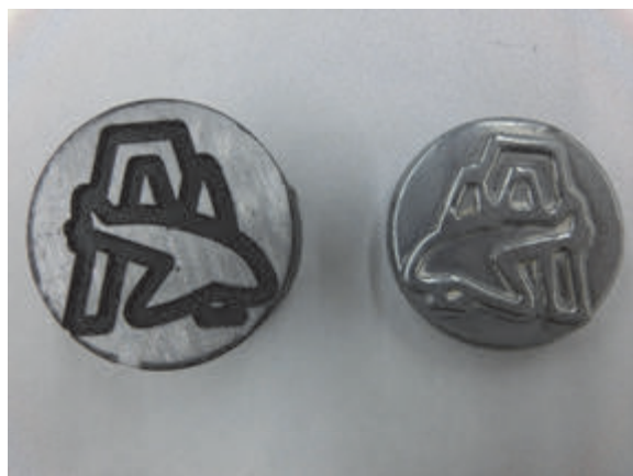
図 6 デザイン型(左)と鑄込んだオリジナルメダル(右)
