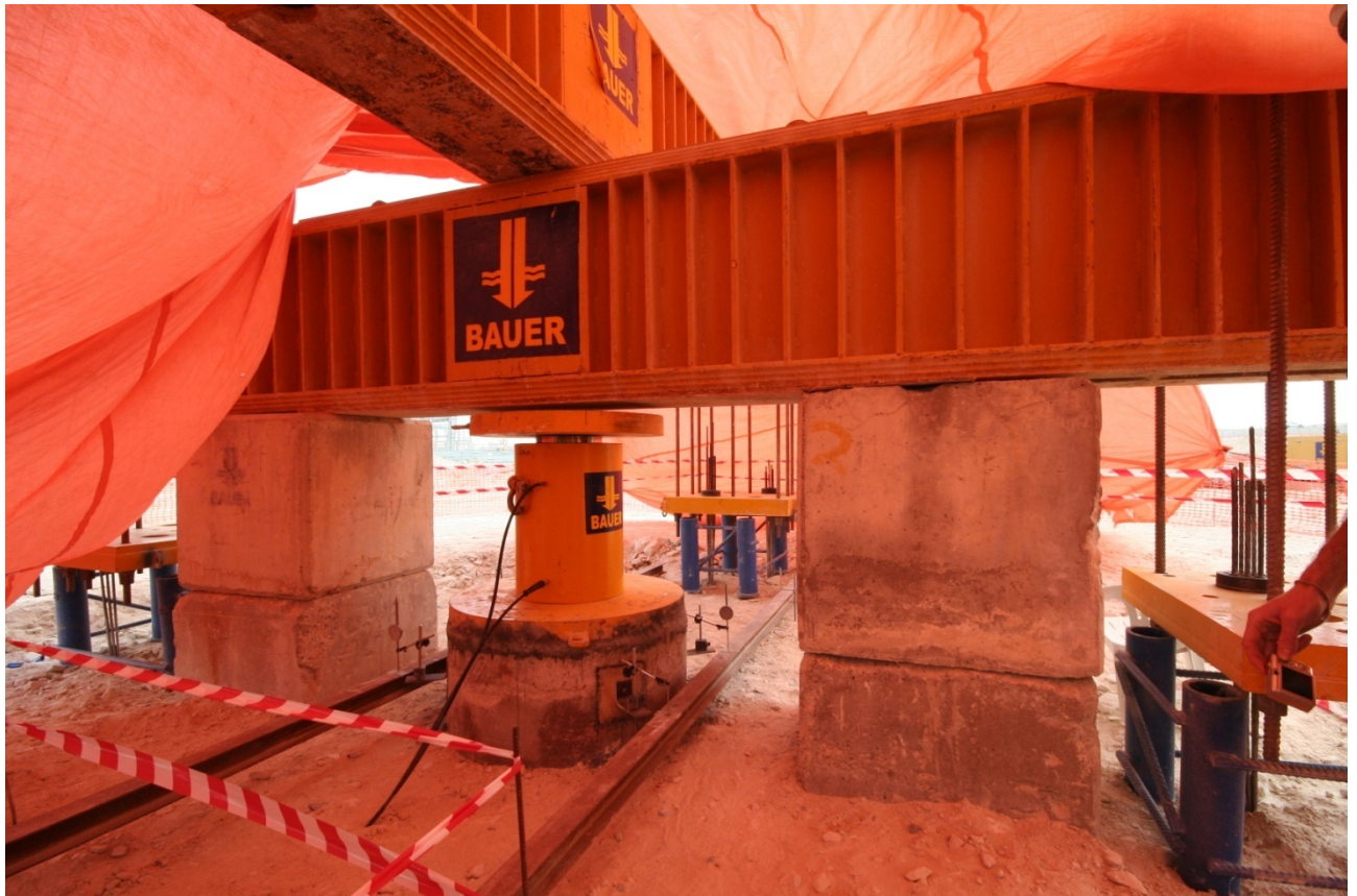
Bild 12: Versuchsanordnung für die Probelastung (Foto: Horst Werkle)
