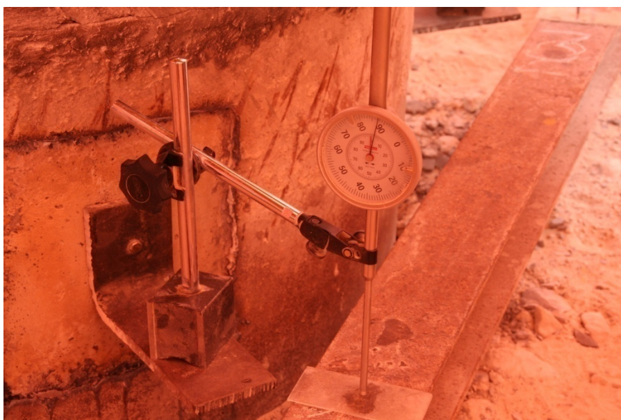
Bild 13: Setzungsmessung im Versuch (Foto: Horst Werkle)
