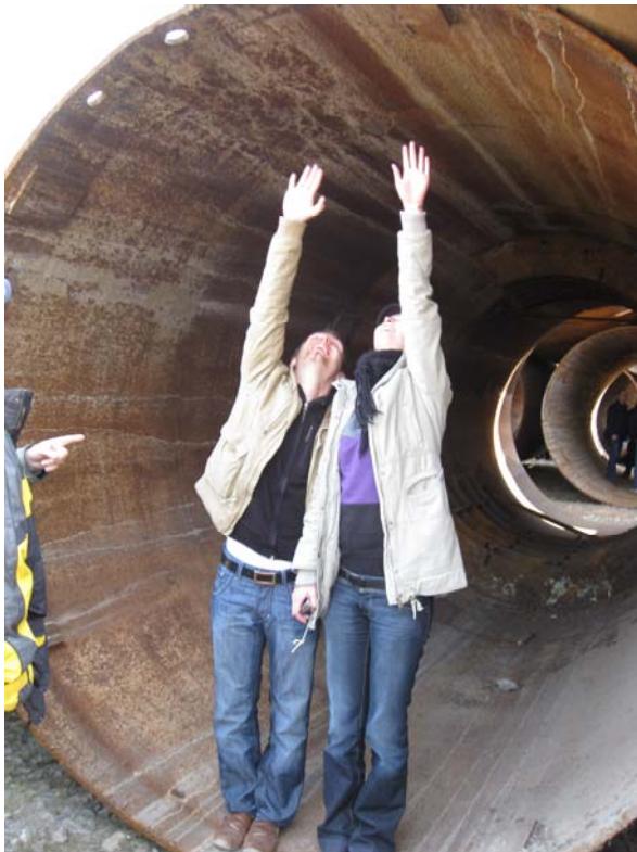
Bild 3: Rohre zur Herstellung der Großbohrpfähle (Foto: Horst Werkle)
