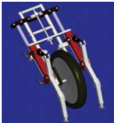
Abb. 13: CAD-Darstellung des Einzelabstützungssystems-Version 2
