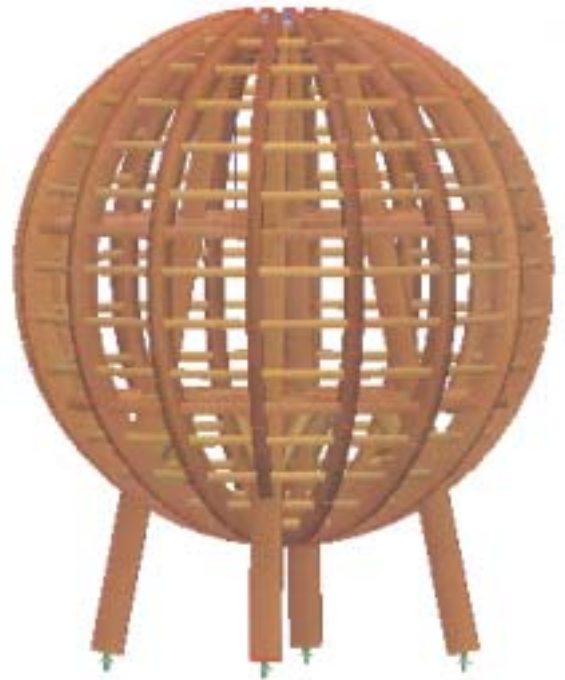
Abb. 5: Statisches Modell - gerendert
