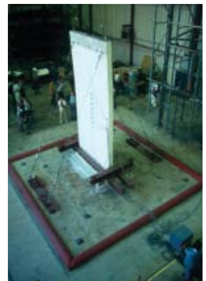
Abb. 8: Wand aus bewehrtem Mauerwerk auf dem Erdbeben-Rütteltisch der University of California, Berkeley
