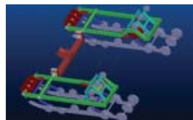
Abb. 10: CAD-Darstellung des linken und rechten Antriebssystems, Antriebseinheiten für die Wintersportversion
