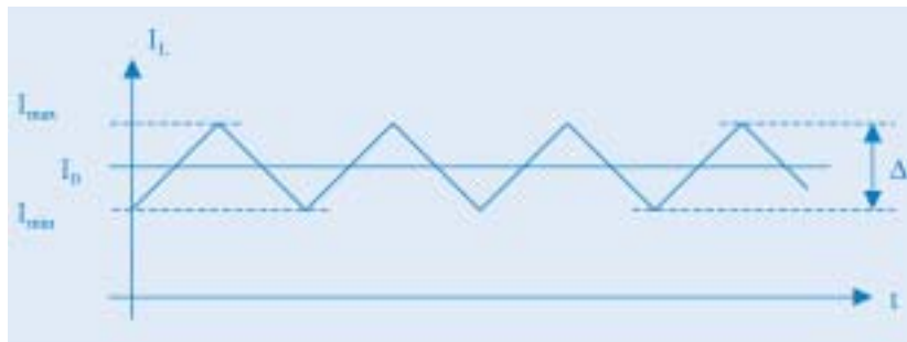
Abb. 1: Prinzipielle Strombelastung einer Drossel im Impulsbetrieb
