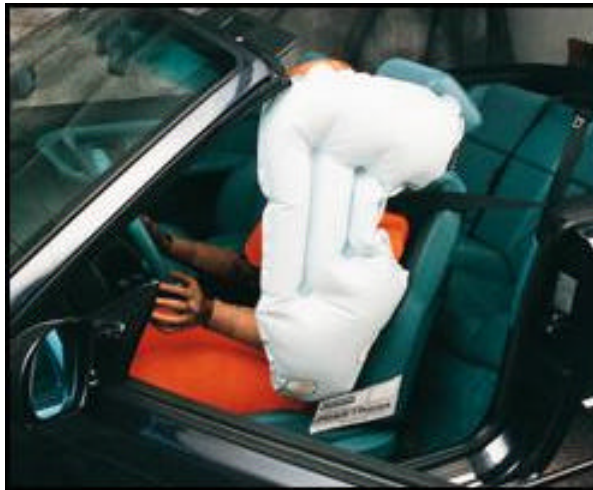
Abb. 5-20 Anordnung des Seitenairbags [21]
