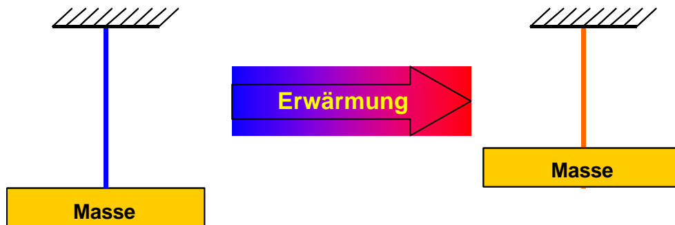
Abb. 4-6 Längenänderung der FGL durch Erwärmung
