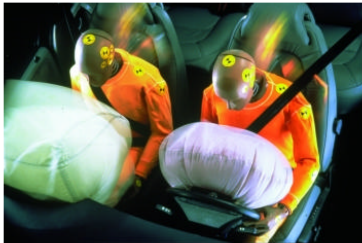
Abb. 5-18 Auslösung des Airbags (Fahrer und Beifahrer) [21]
