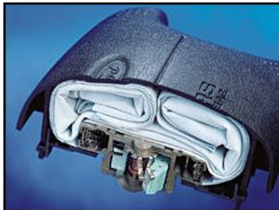
Abb. 5-19 Fahrerairbagsystem im Teilschnitt [21]
