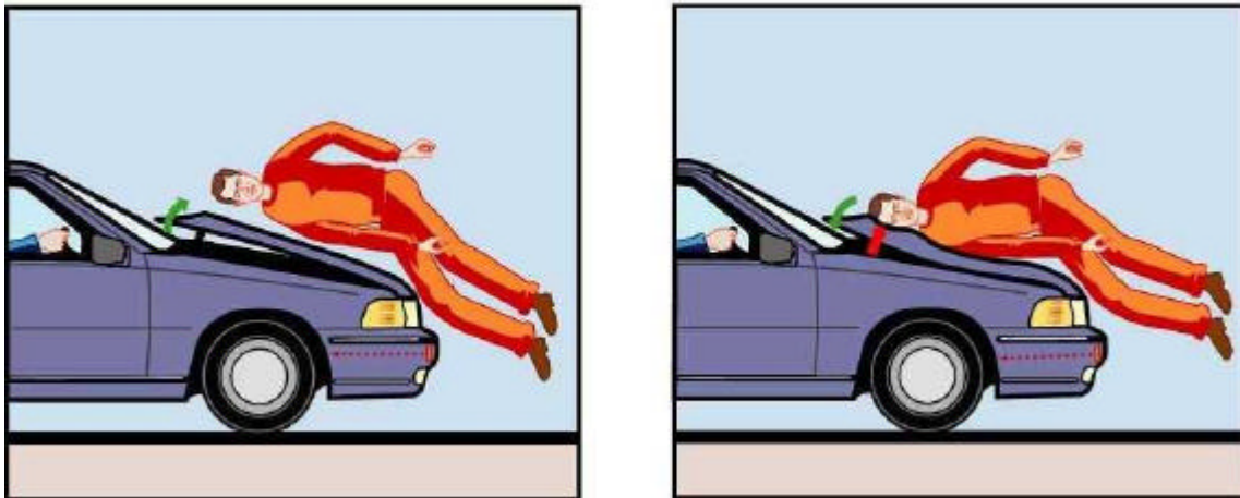
Abb. 6-7 Motorhauben-Anhebung für Fußgänger Schutz [21]
