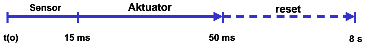
Abb. 7-4 Zeitlicher Verlauf der Motorhauben-Anhebung
