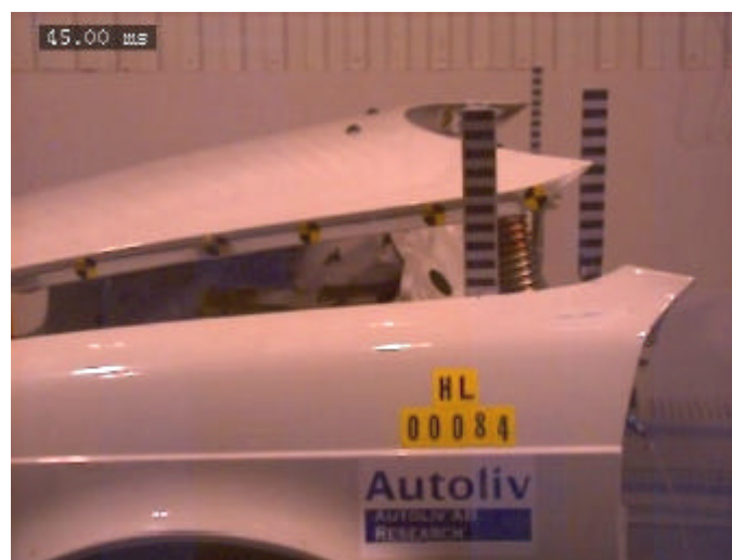
Abb. 7-2 Motorhaube mit Schutzsystem in angehobene Position [30]
