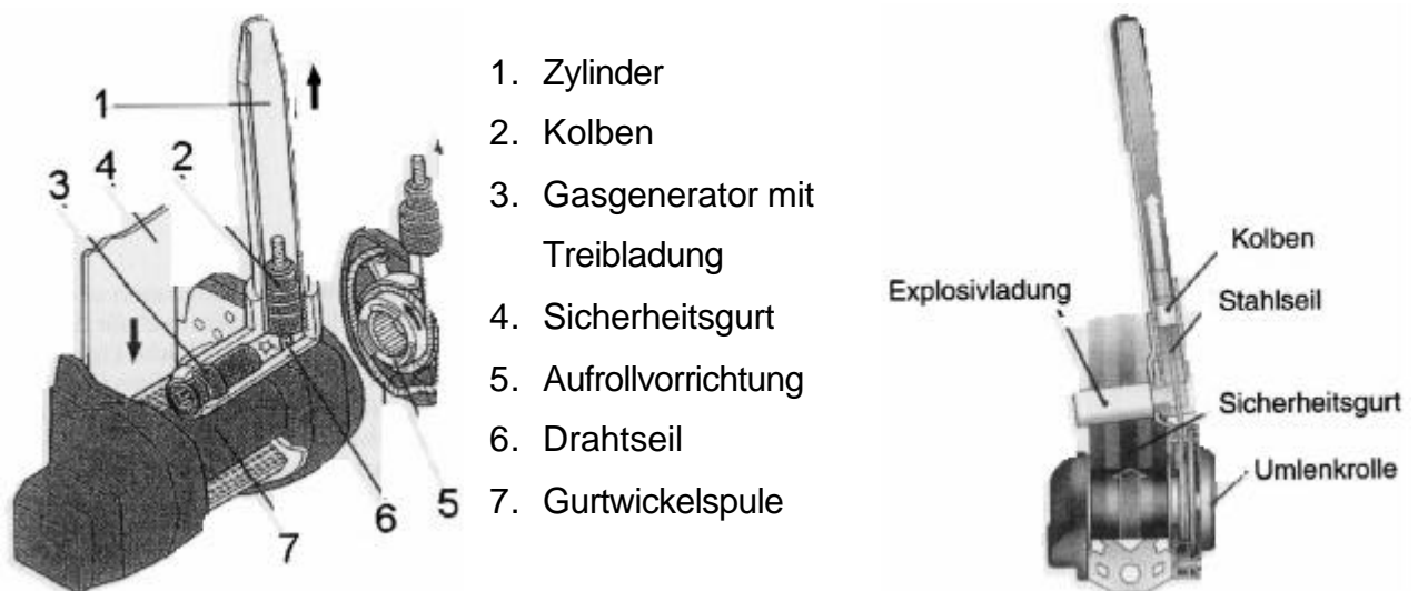
Abb. 5-13 Bauteile eines pyrotechnischen Gurtstraffers und der Aufbau [16]
