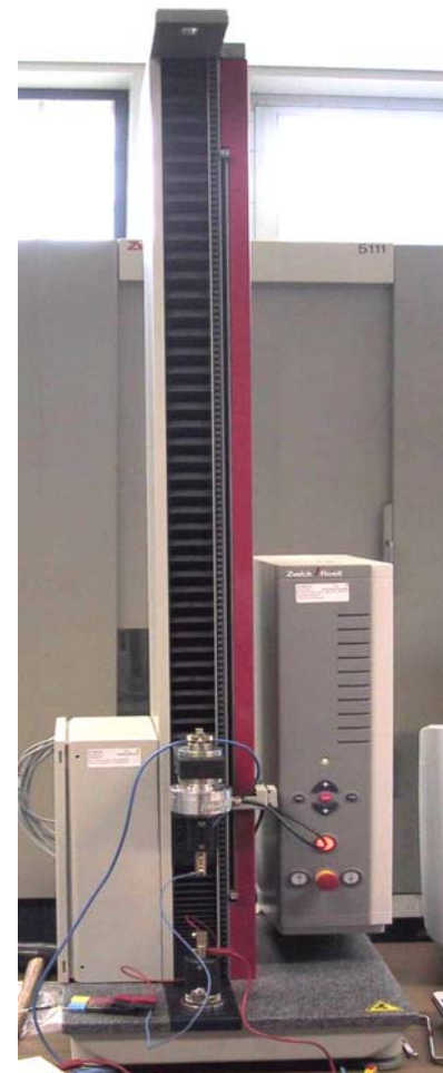
Abb.5.1 Das mechanische Belastungsaggregat in vertikaler Ausführung
