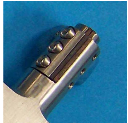
Abb.5.28 Zusätzliche Einsatzplatten für die Probenhalter
