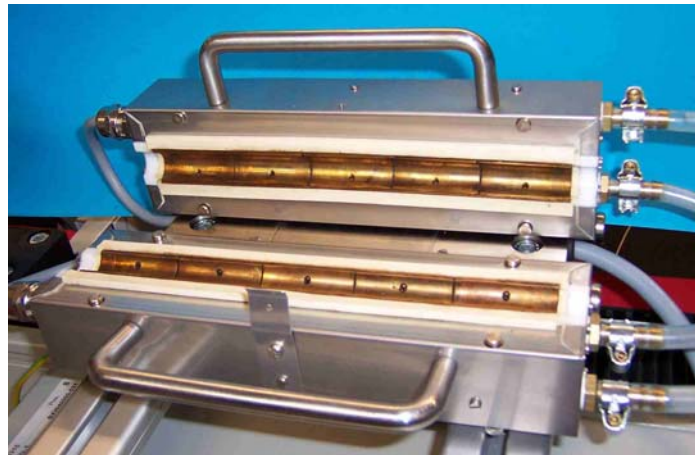
Abb.5.31 Peltier Aggregat (einseitig aufgeklappt)
