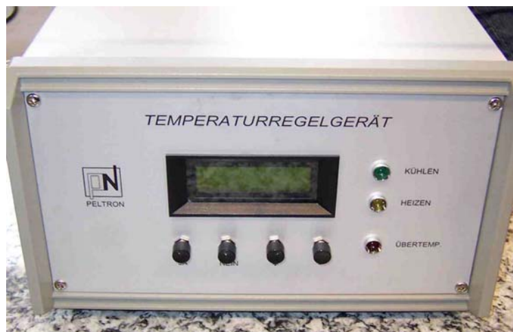
Abb.5.33 Das Peltron PRG RS H400 Regelgerät
