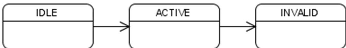
Abb. 6-13: Call Zustandsdiagramm (nach [JTAP02@])
