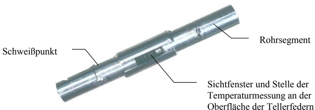
Das Marknagel-Rohr besteht aus körperverträglichem Stahl mit der Werkstoffnummer 1.4435. In der Innenwand der Rohrsegmente ist das zu den Sperrern passende Sägezahnprofil eingedreht. Nachdem erste Versuch mit einem Zahnwinkel von  $45^\circ$  zu hohe Reibkräfte beim Gleiten ergaben, wurde das schließlich im Prototyp verwendete Sägezahnprofil mit einem Neigungswinkel von  $60^\circ$  gefertigt.
