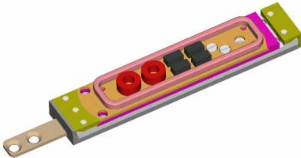
Abbildung II-1 Mechatronische Osteosyntheseplatte (CAD-Abbildung). Nicht abgebildet: Ti-Knochenschrauben
