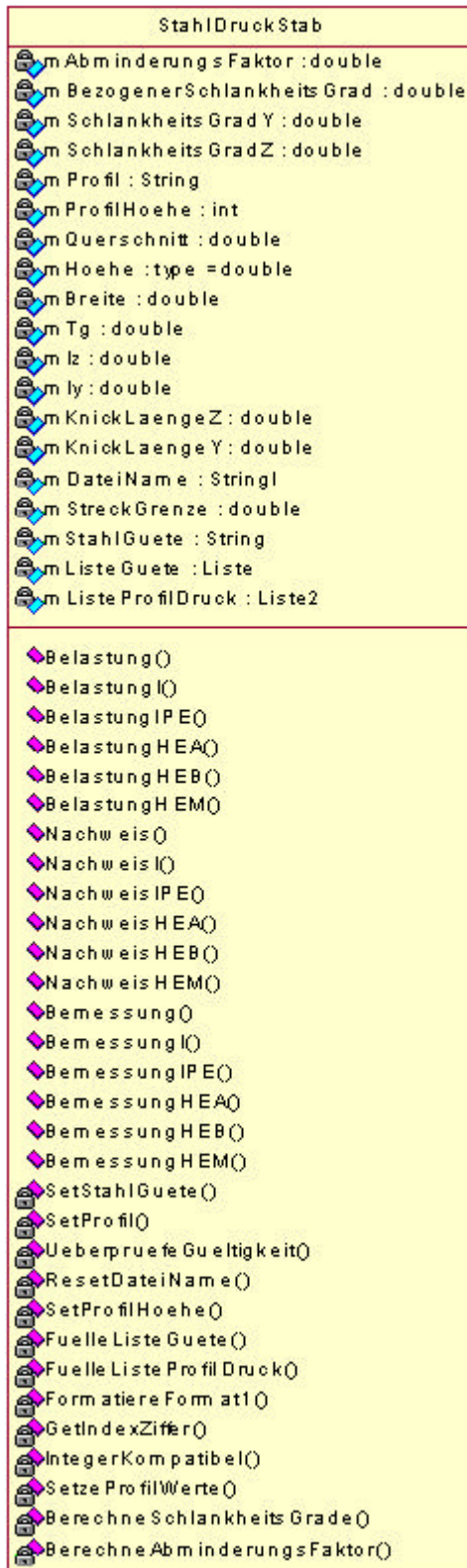
Bild 87. UML Darstellung der Klasse StahlDruckStab
