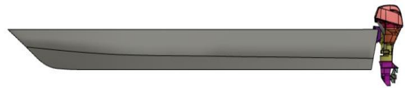
Gambar 6. 3D Model Transom Variasi 0,6 Meter
