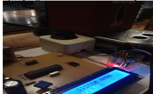
Gambar 6. Jumlah Aliran Listrik Yang Diterima Oleh Mesin Kopi Espresso Delongi Sebanyak 220v
