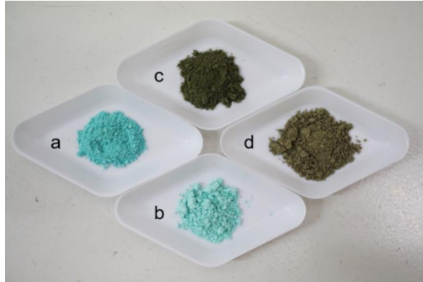
Abbildung 15: Präkursoren der kupferbasierten Katalysatoren gefällt mit \text{Na}_2\text{CO}_3 -Lösung a) Cu/ZnO/ \text{Al}_2\text{O}_3 b) Cu/ZnO/ \text{Al}_2\text{O}_3 /Mn c) Cu/ZnO/MgO d) Cu/ZnO/MgO/Mn.
