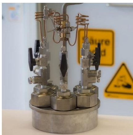
Abbildung 11: Multiplexreaktorsystem im Heizmantel mit sechs Einzelautoklaven verbunden über eine Spinne zur Gasbeaufschlagung (Foto: Michael Piller).
