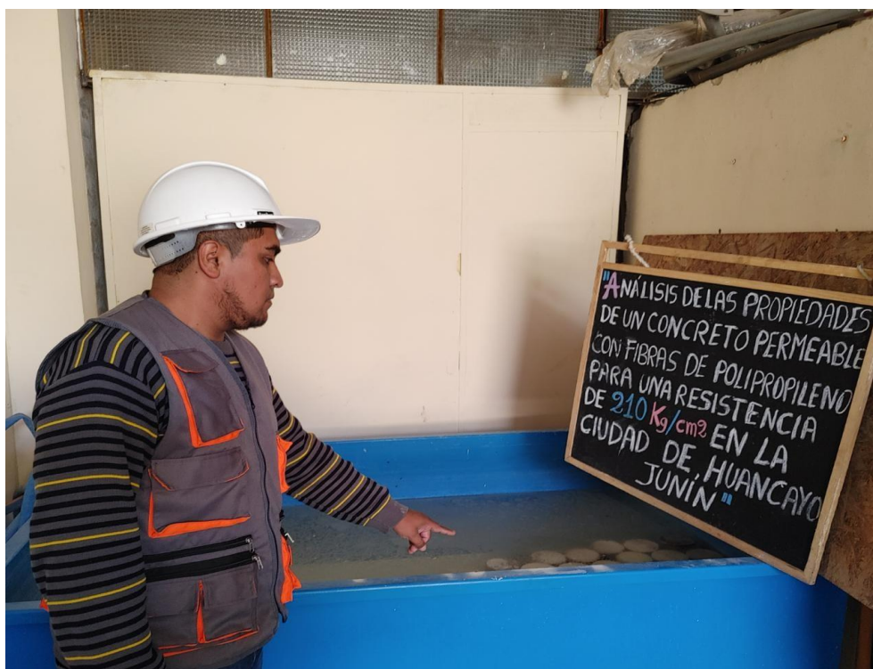
Figura N° 17: Curado de las probetas y vidas de concreto permeable
