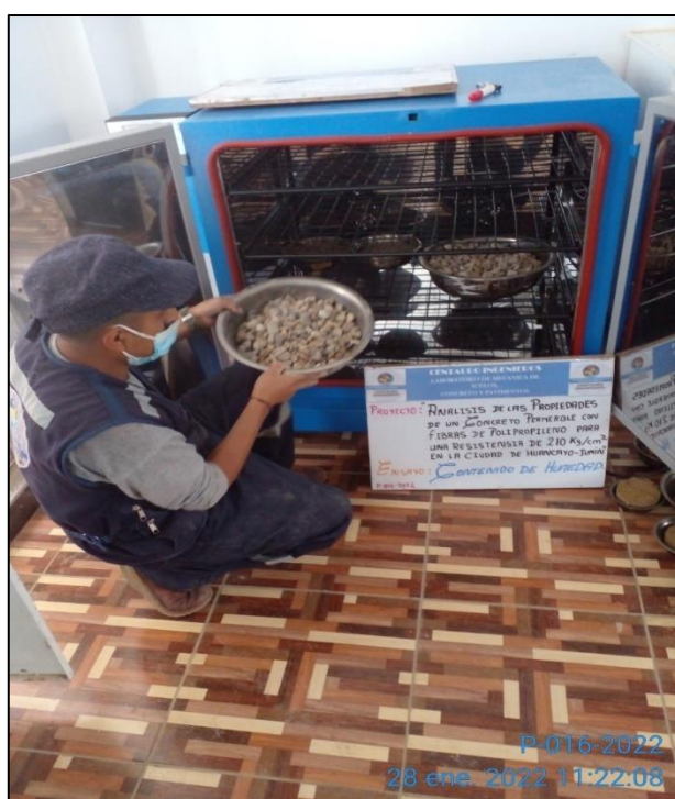
Figura N° 10: Ensayo de contenido de humedad de los agregados para la elaboración del concreto permeable
