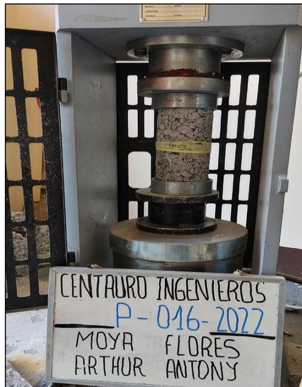
Figura N° 19: Ensayo de la resistencia a compresión del concreto permeable a ser adicionados las fibras de polipropileno
