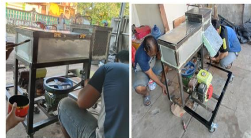
Gambar 4. Hasil Perakitan Mesin pencacah limbah kalamud
