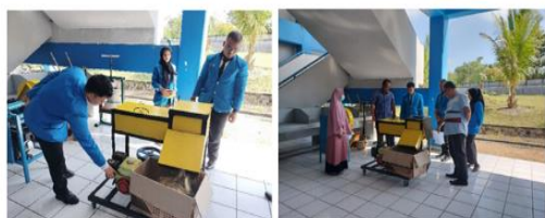
Gambar 6 Ujicoba Mesin Pencacah limbah kelimud
