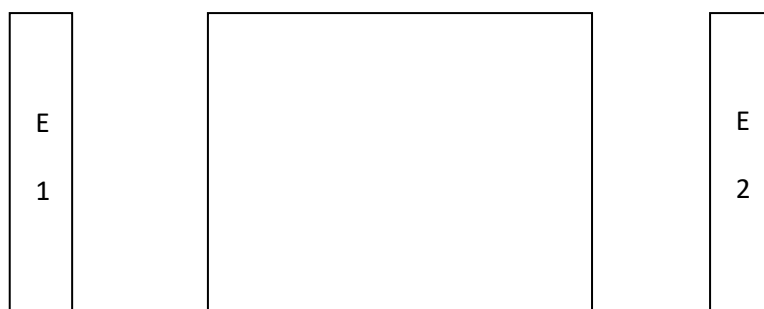
Figura 3.12. Representación gráfica de una cavidad formada por dos espejos
