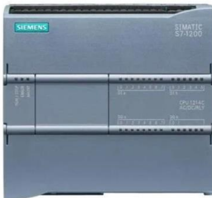
Figura 1: Controlador SIMATIC S7-1200 Fuente: https://w5.siemens.com
