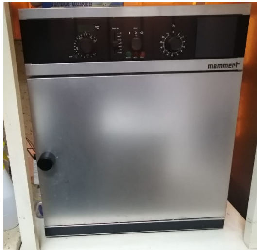
Figura 47. Colocación de la planta girasol a la estufa por 24 hrs a 70 °C
