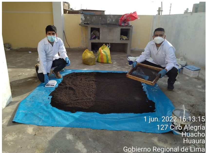
Figura 8. Homogenización de la muestra compuesta obtenida de los cuatro talleres de mecánica
