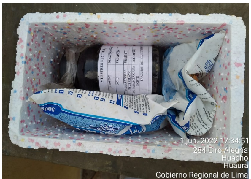
Figura 9. Muestra inicial de suelo residencial para el análisis de hidrocarburos de fracción F2
