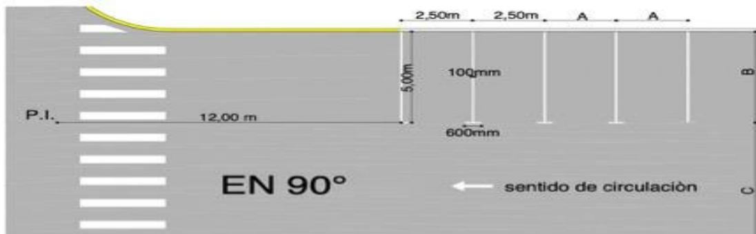
**Ilustración 5-2:** Estacionamiento en batería de 90 grados
