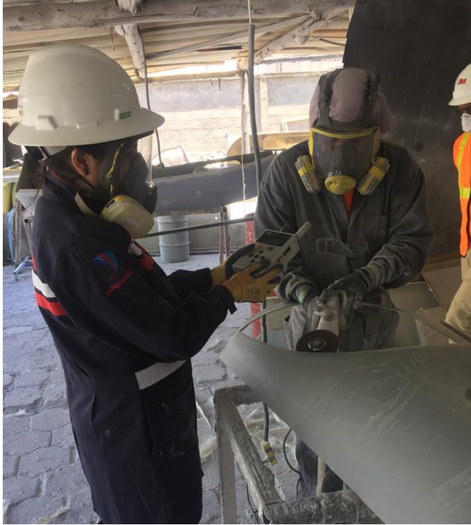
Imagen 12: Toma de muestra día 3 con el contador de partículas de mano AEROCET 531S.
