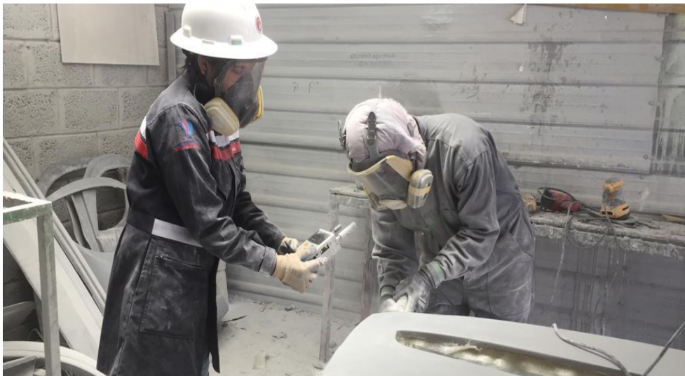
Imagen 13: Toma de muestra día 4 con el contador de partículas de mano AEROCET 531S.
