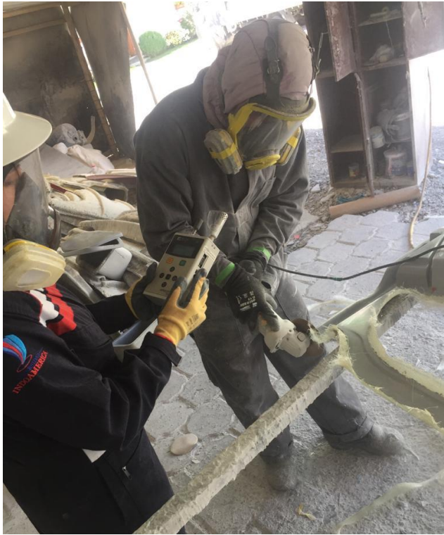
Imagen 14: Toma de muestra día 5 con el contador de partículas de mano AEROCET 531S.
