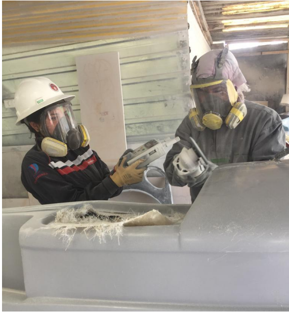
Imagen 10: Toma de muestra día 1 con el contador de partículas de mano AEROCET 531S.
