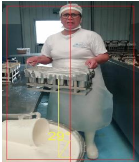
Figura 33: Calculo del factor de asimetría en el origen. Fuente: Empresa HELADOS SOVRANA SAINEC S.A Elaborado por: El investigador.
