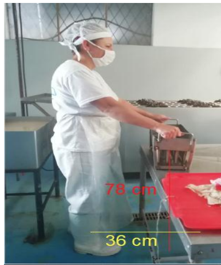
Figura 42: Medidas verticales y horizontales en el destino. Fuente: Empresa HELADOS SOVRANA SAINEC S.A Elaborado por: El investigador.
