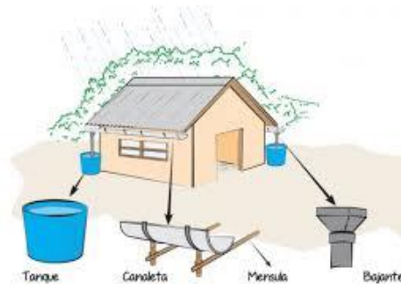
Imagen N.- 55 Sistema de recolección de aguas lluvias
