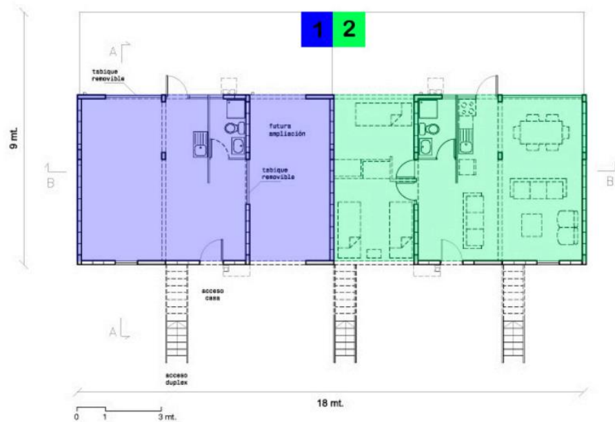
Imagen N.- 23 Tipología de Vivienda Tipo A, Planta baja Fuentes: Plataforma Arquitectura, 2015. "Tipología de Vivienda Tipo A, Planta baja" Modificado: G. Guerrero, 2017
