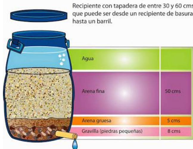
Imagen N.- 57 Sistema de filtro casero para aguas lluvias Fuente: “Sistema de filtro casero” Araque A., 2017}
