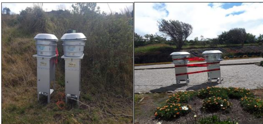
Fotografía N° 31. Instalación de la estación de monitoreo de Calidad de Aire.
