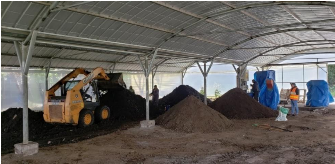
Fotografía N° 18. Volteos continuos con la mini cargadora
