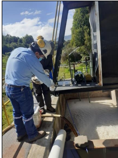
Fotografía N° 34. Muestreo de Lixiviados en la Planta de Tratamiento
