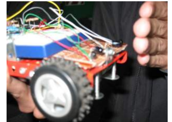
Figura 3. Robot móvil con sensor de proximidad.
