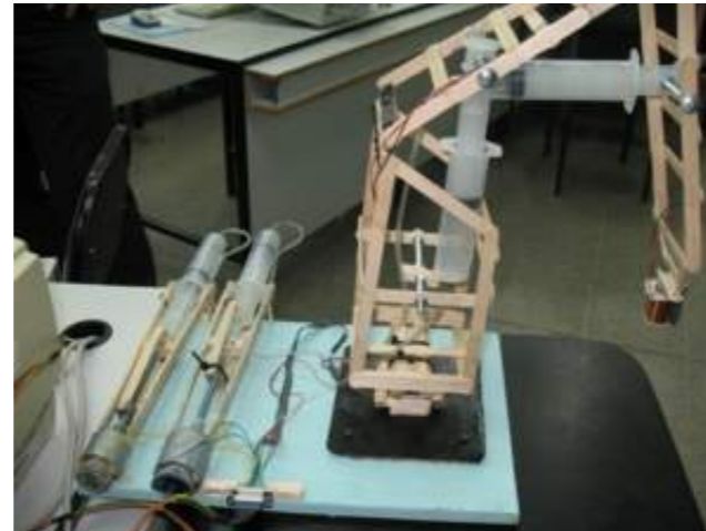
Figura 5. Brazo manipulador por medio neumático controlado por PC. Fuente: Curso de Técnicas Avanzadas II, Carrera de Electrónica, CUC.
