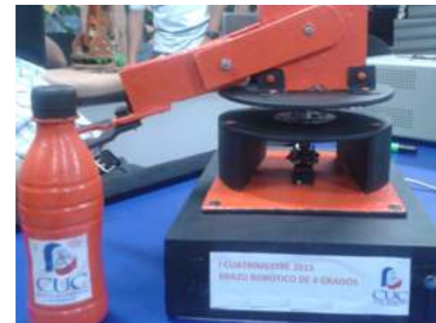
Figura 10. Robot SCARA Pick and Place controlado por ARDUINO. Fuente: Curso de Robótica y Automatización, Carrera de Electrónica, CUC.
