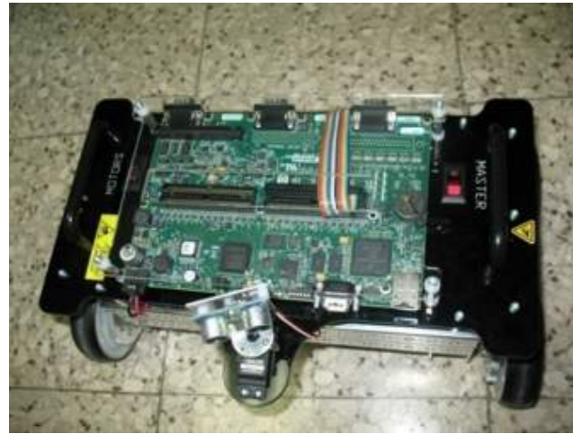
Figura 4. Robot móvil con sensor ultrasónico microprogramado. Fuente: Curso de Técnicas Avanzadas II, Carrera de Electrónica, CUC.
