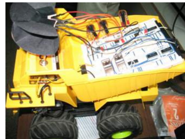
Figura 2. Robot móvil seguidor de luz.
