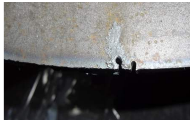
Figura 2. Mordeduras generadas durante el proceso de corte manual. Fuente: ATU Artículos de Acero S.A. Elaborado por: El investigador.
