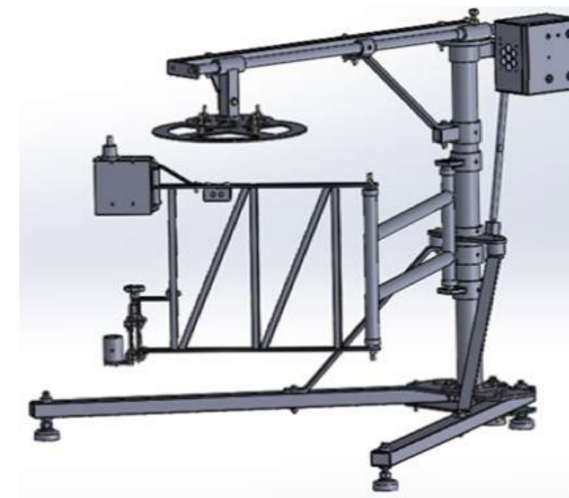
Figura 7. Sistema mecánico para corte por plasma. Fuente: El investigador. Elaborado por: El investigador.
