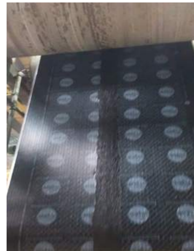
Figura 8. Láminas con polietileno quemado.
