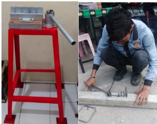
Gambar 10. Alat tekuk portabel dan alat tekuk tradisional
