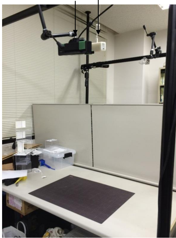
図 2-5 深度センサは手術台全域を撮影し、マーカー追跡センサはメスに付けたマーカーを追跡する(写真は研究室でおこなった実験時のもの).
