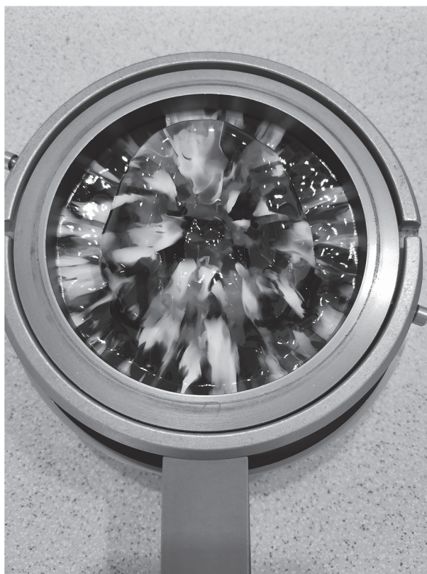
Фиг. 7. Фолио Erkoflex (цветно 4 мм) изтеглено върху модела
