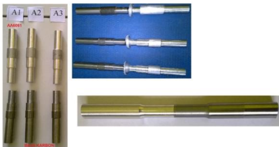
Gambar 4. Benda uji sebelum dan sesudah pengelasan
