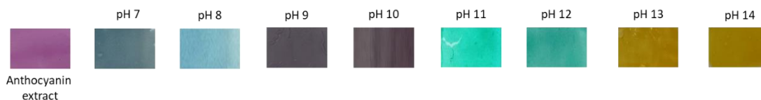
Gambar 3 Perubahan warna film indikator nanoserat selulosa/antosianin pada ragam pH
