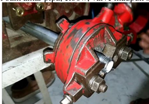
Gambar 5. Proses Menyenai Manual Drat dari Pipa
