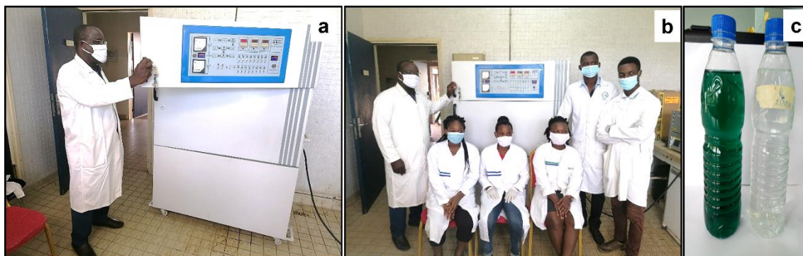
Photo 12 : Pilote d'électrocoagulation fabriqué par l'équipe de recherche et les étudiants FGéPro (a-b) Résultats de traitement des eaux d'une industrie textile à Bouaké (Cote d'Ivoire).
