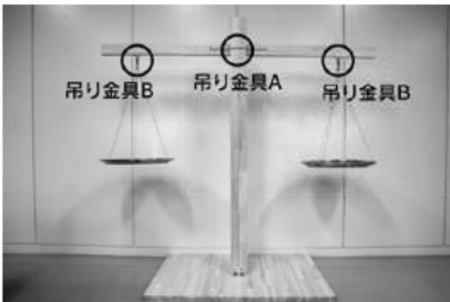
Fig. 3 製作した天秤と吊り金具の位置
