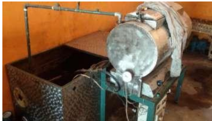
Gambar 1.6 Mesin Vacuum Frying di UKM “Usaha Baru Ibu” sebagai Alat Pembuat Keripik Nenas
