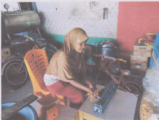
Gambar 4.15 Foto Proses Pengepakan menggunakan Machine Sealer di Atas Meja Rancangan
