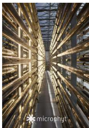
Figura 4 – Exemplo de um biorreator usado para o cultivo de algas em sistema fechado. Imagem cedida pela empresa Microphyt [21].
