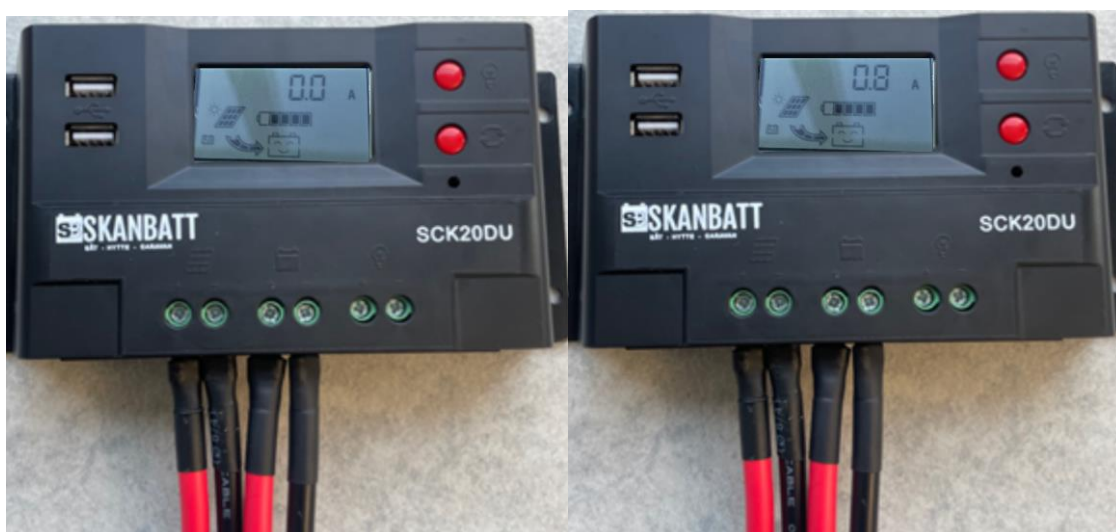
Figur 47. Ladeeffekt fra solcellene til batteriet i ingen og indirekte sollys 16.11.22
