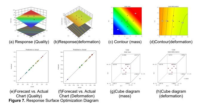
$Total \ deformation = +1.48784 - 0.009484 * d4 + 0.000220 * d3 + 0.000228 * d2$  $+0.059409 * d1 + 0.028771 * d5 + 0.001886 * d4^2 - 0.004064 * d1^2 - 0.009368 * d5^2$ (1)  $Total \ mass = 11.48305 + 0.871769 * d4 + 0.788938 * d3 + 0.788938 * d2 +$ 2.67332 \* d1 + 1.65877 \* d5(2)
