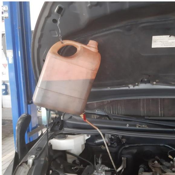
Gambar 1. Proses Pengisian Oli Transmisi Otomatis
